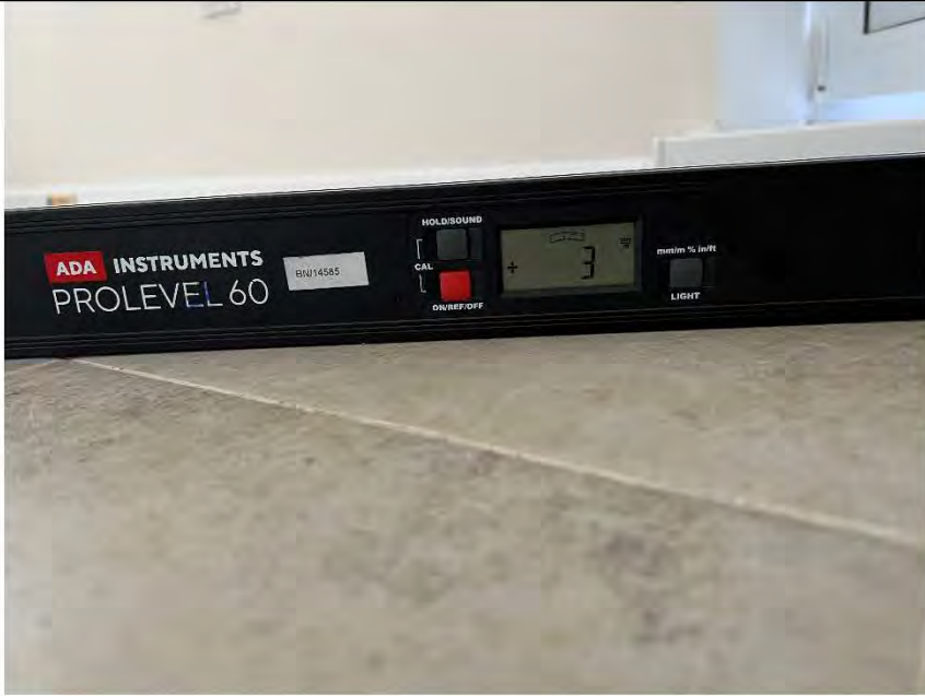
Фото №25. Измерение уровня напольного покрытия в кухне.
