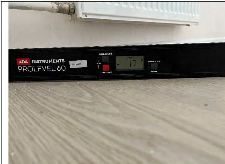
Фото №22. Измерение уровня напольного покрытия в кухне.
