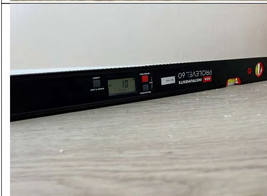
Фото №23. Измерение уровня напольного покрытия в спальне.
