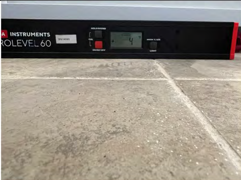
Фото №26. Измерение уровня напольного покрытия в ванной комнате.
